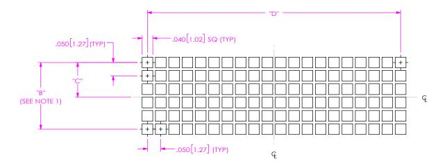
FIG 2 LPAM-20-XX.X-X-06-K-TR STENCIL SHOWN
